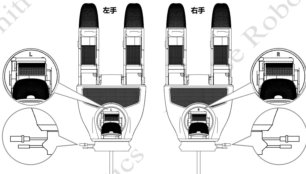
放置灵巧手，放入抱箍(注意线缆)，拧紧两颗 M3 螺钉，如下图。
